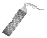
5. Retire las dos rejillas de ventilación empujándolas con cuidado hacia abajo.
