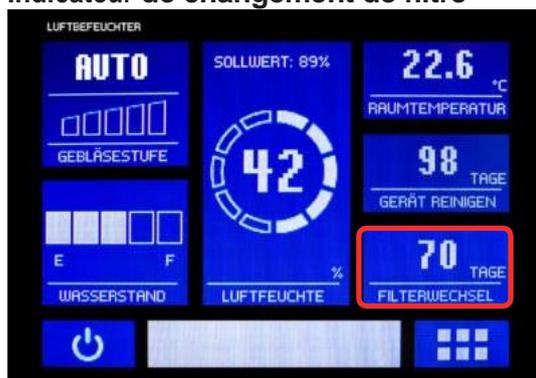
Fig. 5.1.7 : Affichage du prochain changement de filtre recommandé
