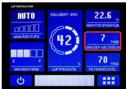
Fig. 5.1.5 : Affichage du prochain changement d'eau recommandé
