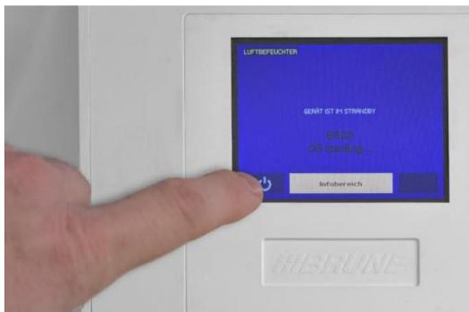
Fig. 5.2.1 : Mise en marche de l'appareil
