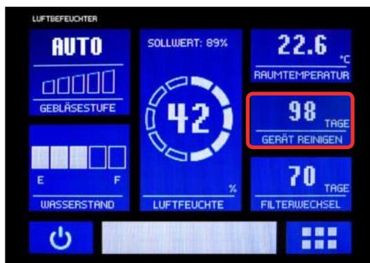
Fig. 5.1.6 : Affichage du prochain nettoyage recommandé
