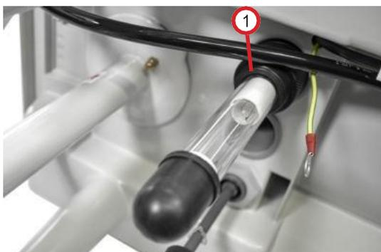
Fig. 8.1.2.6 : Lampe UV dans un tube en verre de quartz.
