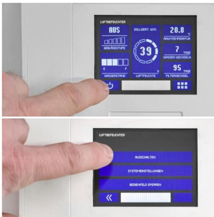
Fig. 5.2.2 : Éteindre l'appareil
