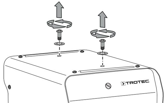
2. Monte el asa de transporte mediante los dos tornillos y las arandelas.
