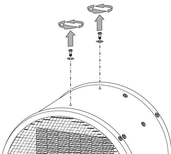
2. Pomocí dvou šroubů a podložek namontujte držadlo na přenášení .
