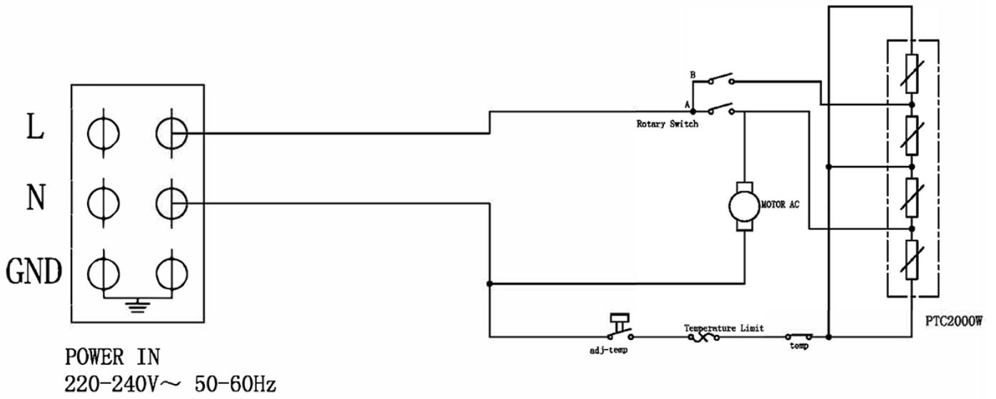
**Schéma électrique TDX 19**
