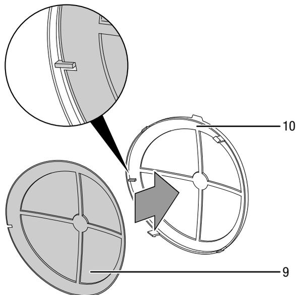
6. Coloque o filtro de ar de volta no aparelho.
