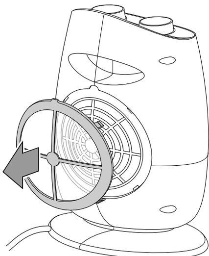
5. Coloque a inserção do filtro (9) novamente no suporte do filtro (10). Tenha em atenção que as marcas no suporte do filtro (10) ficam engrenadas na ranhura prevista para a inserção do filtro (9). A inserção do filtro (9) deve engrenar no suporte do filtro (10).
