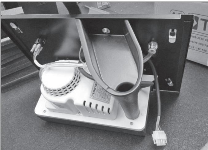
3. Stecken Sie nun den Verbindungsstecker (verpolungssicher) der Pumpe in das Gegenstück im Gerät: es befindet sich in der rechten, oberen Rückwand des Geräteteiles, wo sich der Kondensatbehälter befand.
