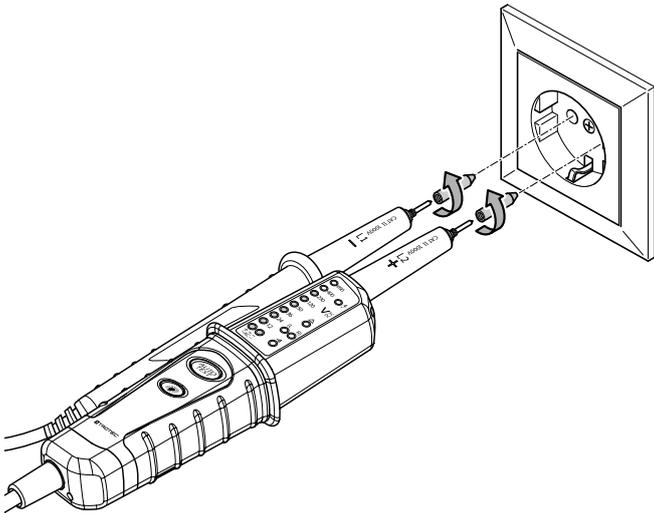
1. Appliquez les deux pointes de test (1, 2) sur les points de mesure de la source de tension à contrôler.
