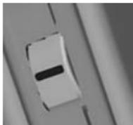
Contrairement aux appareils de mesure manuels conventionnels, le T2000 possède une molette « THUMB-WHEEL » sur le côté gauche.
