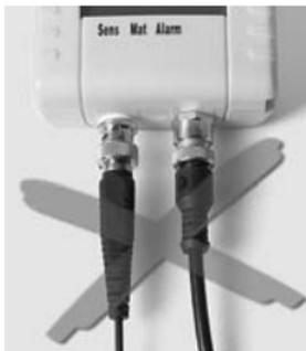
**IMPORTANT : Le T2000 S permet de raccorder divers capteurs, mais il ne faut jamais raccorder plusieurs capteurs pour une mesure – brancher un seul capteur à la fois !**
