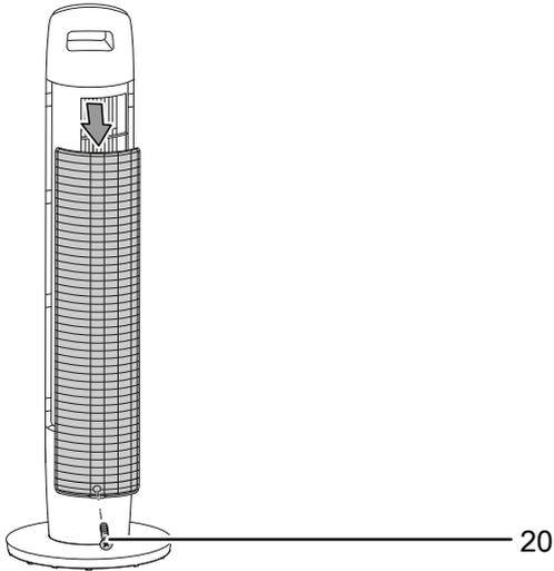
2. Pulire la copertura dell'involucro del corpo del ventilatore con un panno umido, morbido e senza pelucchi. Fare attenzione che non penetri umidità all'interno dell'alloggiamento. Fare attenzione che l'umidità non entri in contatto con gli elementi costruttivi elettrici. Per inumidire il panno, non utilizzare detergenti aggressivi, come ad es. spray detergenti, solventi, detergenti a base di alcool o abrasivi.
