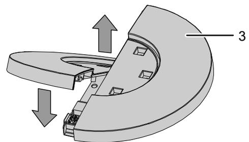
2. Ruotare di circa 90° le due chiusure delle pale (5) al di sotto del piedino d'appoggio, per fissare le due parti del piedino d'appoggio tra loro.
