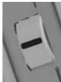
A la différence des appareils de mesure à main courants, cet appareil ne possède pas de clavier mais une « molette de commande » située sur le côté gauche.
