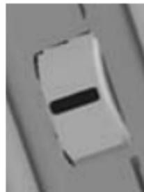
Im Gegensatz zu konventionellen Handmessgeräten besitzt das Messgerät kein Tastenfeld, sondern ein so genanntes „Daumen-Rad“ auf der linken Seite des Gerätes. Das Rad lässt eine 15° Drehbewegung nach unten und oben zu und kann in der Mittelstellung zusätzlich gedrückt werden.
